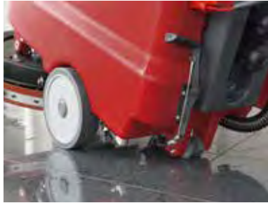
Über das Stützrad kann die Maschine einfach transportiert oder Bürsten schonend abgestellt werden.
