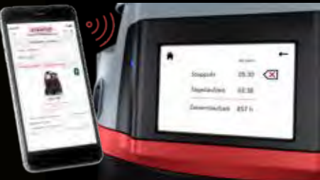
Auslesen/Synchronisieren von Gerätedaten über Bluetooth-Schnittstelle.
