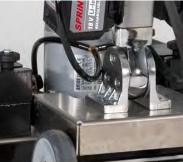
Pre-Pad-Schutz: verhindert Beschädigungen der Kletthaken an der Maschine, z.B. beim Abstellen ohne Pad
