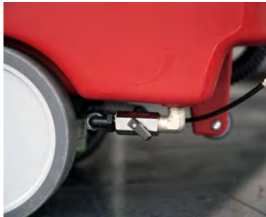
Wassermenge kann individuell auf jeden Bodenbelag eingestellt werden.
