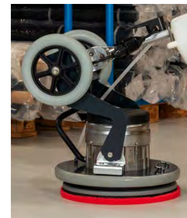
Kippbare Deichsel zur Erhöhung des Anpressdruckes.
