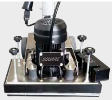
Einfacher Transport: schnelle (De-)Montage der Gewichte
