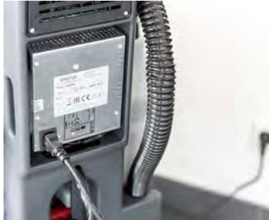
Internes Ladegerät mit Ladestandsanzeige.
