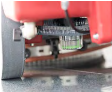
Frischwasser kann restlos und bequem über den Schnellverschluss abgelassen werden.
