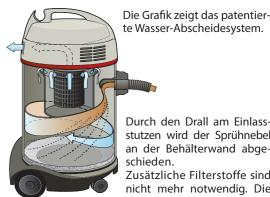
Durch den Drall am Einlassstutzen wird der Sprühnebel an der Behälterwand abge-
